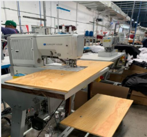
Figura 1. Muebles de apoyo (madera)
